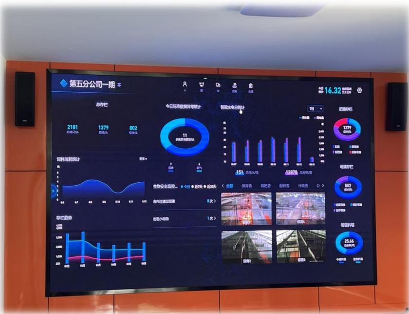
公司智能猪场监控预警体系充分利用由物联网、大数据、5G、AI等先进技术集成的智慧可视化平台，实时采集猪场环境参数、料耗、水耗、电耗等数据通过可视化监管平台实现对各猪场全天候的远程监控实施掌握猪群生长情况、人员工作情况、设施运行情况及异常警报等信息，切实提高了公司对各猪场的远程化管理能力及突发事件响应效率，为生猪养殖构建起最佳的饲养环境。
