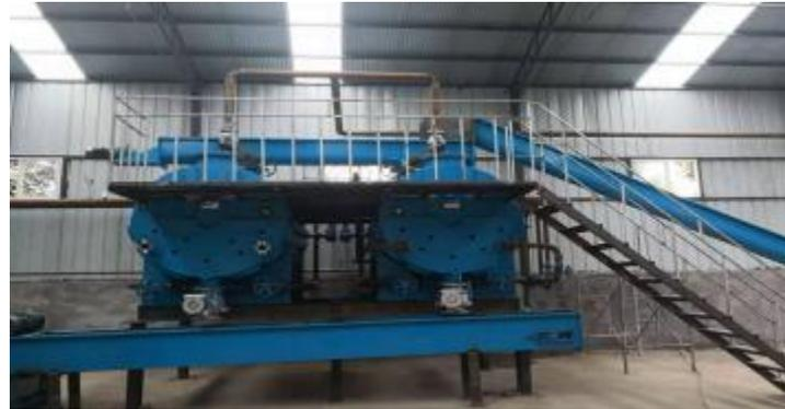
猪场内部将死猪处理：该设备可通过高温高压处理病死猪尸体，达到熟化灭菌，起到提高生物安全等级及保护环境的作用。
